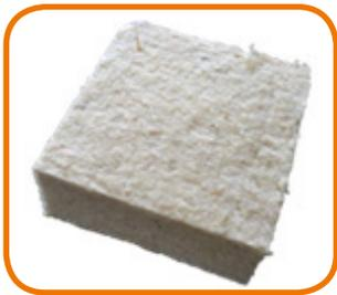
Après lavage, la laine de mouton peut être conditionnée sous forme de panneaux ou rouleaux.
