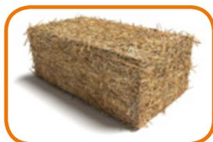
Après fauchage, la paille est en général conditionnée sous forme de bottes. Celles-ci peuvent être utilisées telles quelles comme isolant dans une ossature bois.
