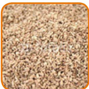
Les granulats de liège sont utilisés en remplissage de caissons ou mélangés à du béton afin d'obtenir une chape légère et isolante.
