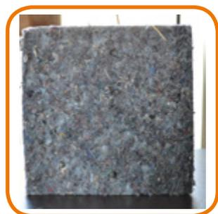
Le textile recyclé peut être conditionné sous forme de panneaux et rouleaux.
